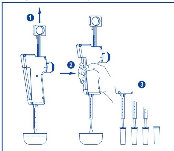
Tirare lentamente l'asta verso l'alto al fine di aspirare il liquido ❶. Verificare l'assenza di bolle d'aria nella colonna del liquido. Premere completamente il grilletto, scaricare il primo colpo ❷. Rilasciare il grilletto fino allo stop e rilasciare completamente per ogni dose ❸.
